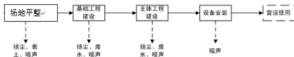
图 2-2 施工期工艺流程图
